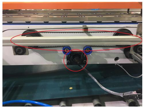
THE SMALL CIRCLE IS SERVO MOTOR( EACH SIDE HAVE ONE ) , ALL THE CIRCLES ARE SERVO MOTOR SYSTEM TO PUSH THE PAPER .
